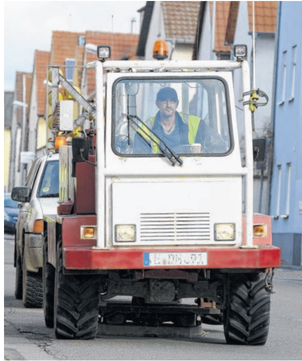
Mit Minivibratoren (links) und Hunderten von Kilometern Kabel in der Region auf der Suche nach Kohlenwasserstofflagerstätten: Auch in unserer Region hat ein Firmenkonsortium die Abbaumöglichkeiten von Erdgas und Erdöl 3D-seismisch geprüft. BILD: VENUS
