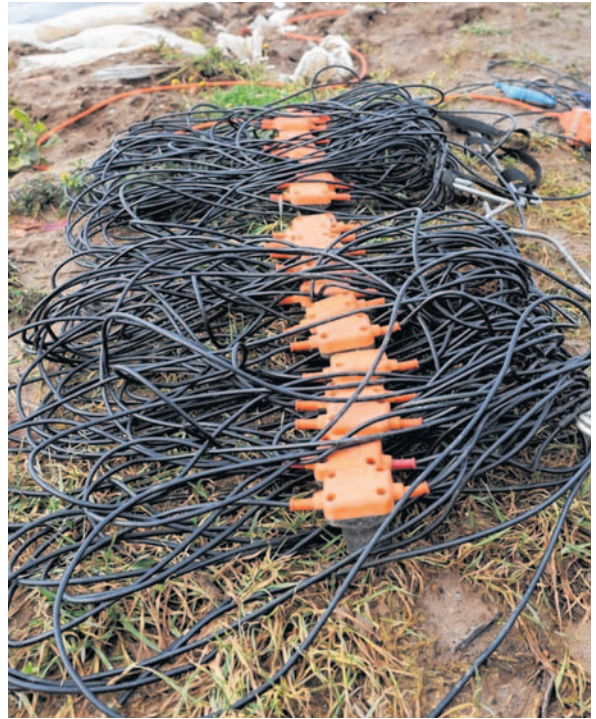
Mit Minivibratoren (links) und Hunderten von Kilometern Kabel in der Region auf der Suche nach Kohlenwasserstofflagerstätten: Auch in unserer Region hat ein Firmenkonsortium die Abbaumöglichkeiten von Erdgas und Erdöl 3D-seismisch geprüft. BILD: VENUS
